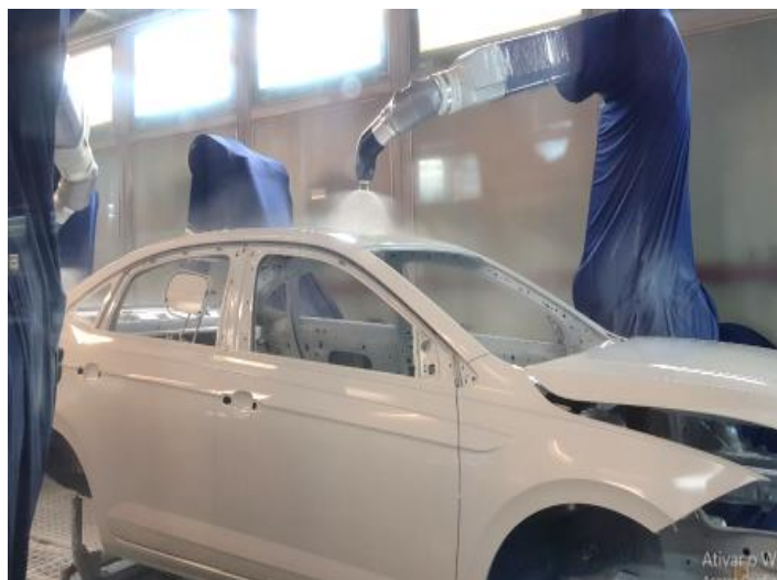
Figura 16 - Processo de pintura robotizado Fonte: VM (2018).
