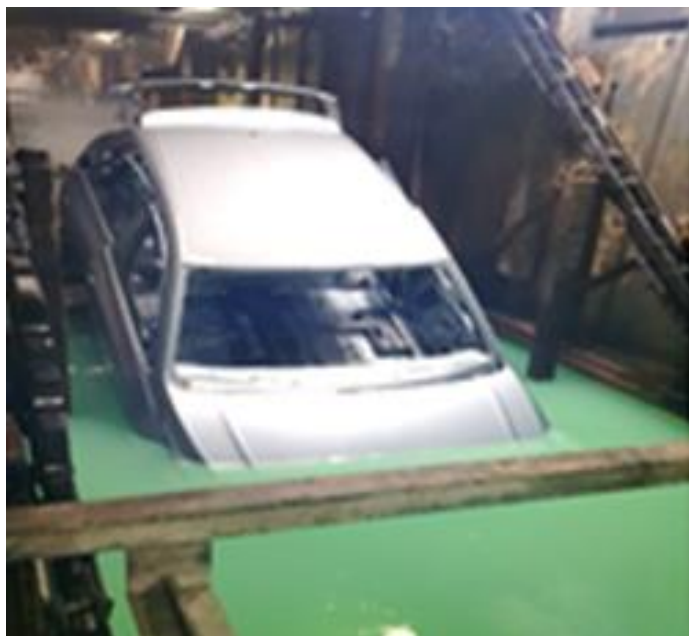
Figura 19 - Lavagem e fosfatização de carrocerias por imersão Fonte: Andreos (2018).
