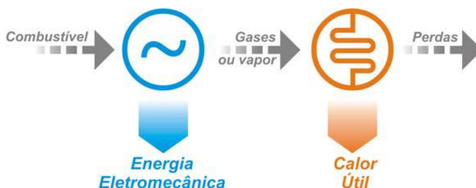
Figura 2 - Cogeração do tipo topping
